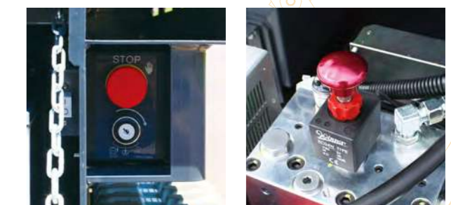
非常停止装置 (非常停止スイッチ)
