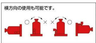
オイルジャッキ 10 トン低床タイプ マサダ製作所製 高さ 170~340mm 横向き使用可能
